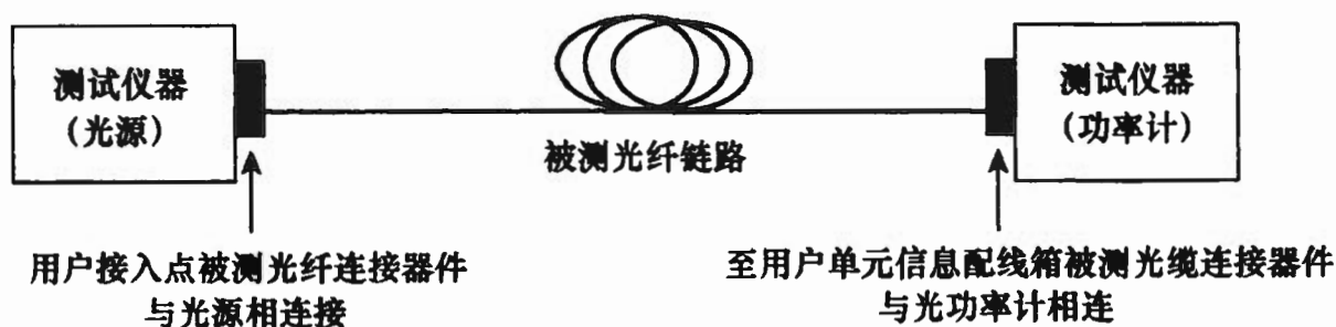
图 C.0.4 光纤链路衰减测试连接方式
