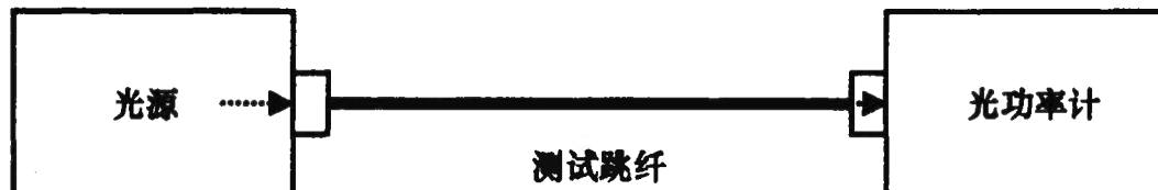
图 2 单跳线测试校准连接方式
