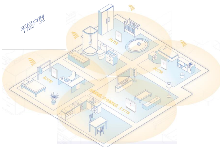
图 4- 2 平层户型 FTTR 系统部署示例
